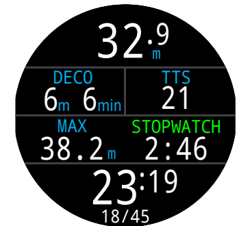
Le chronomètre peut être ajouté à l'écran d'accueil dans tous les modes.
