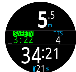
6. Safety Stop (Palier de sécurité)
